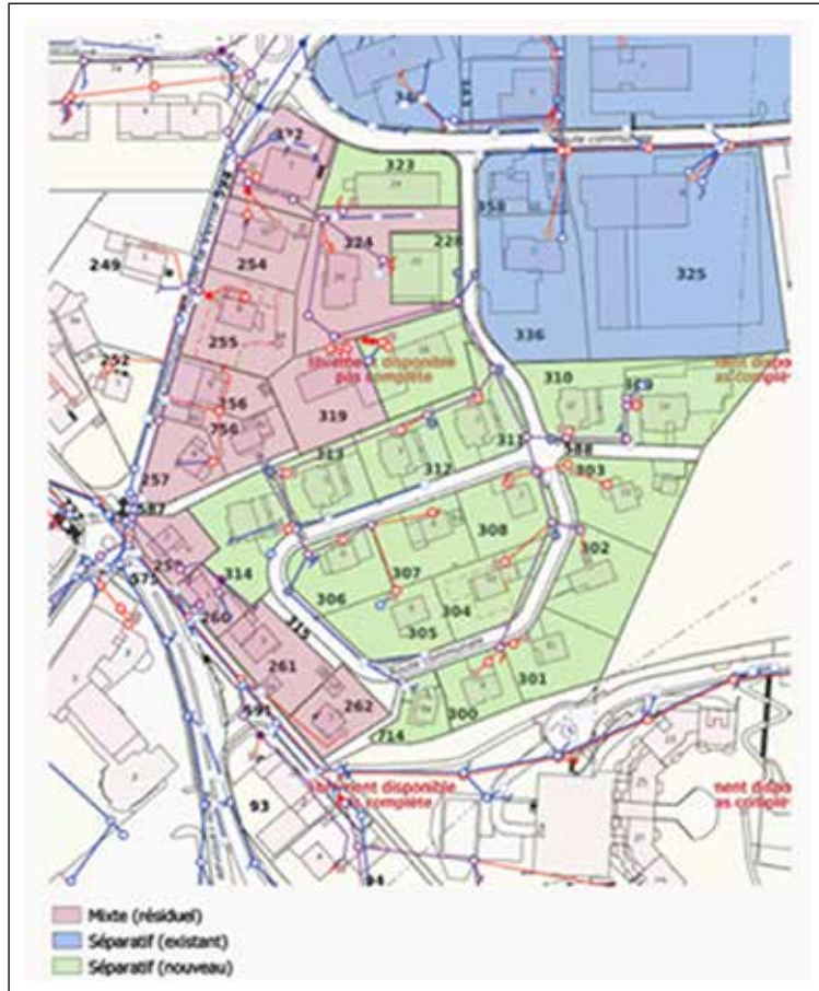
Fin de la Croix : surface mise en séparatif
